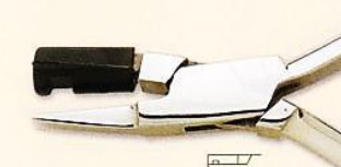
PI-131/B PINCE A INCLINER avec 1 mors nylon demi-rond avec encoche évitant le glissement Acier inoxydable - 140 mm - 100 g PI-131/S INCLINATION PLIER Half round nylon jaw with groove to prevent frame from slipping Stainless steel - 140 mm - 100 g Mors nylon de rechange (1 pc + vis) Replacement nylon jaw (1 pc + screw)
